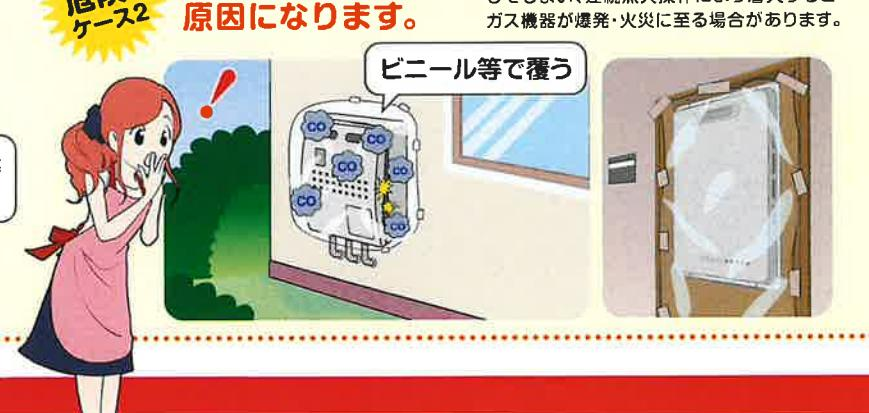
ガス機器が燃焼できなくなり、未燃ガスが滞留してしまい、連続点火操作により着火すると
