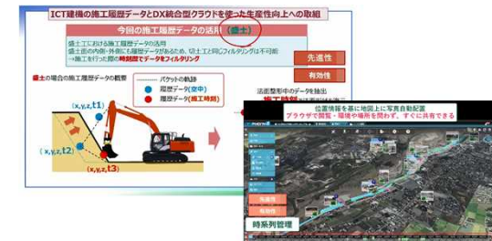
ICT建機の施工履歴データとDX統合型クラウドを使った生産性向上への取組 【株式会社大林組】
