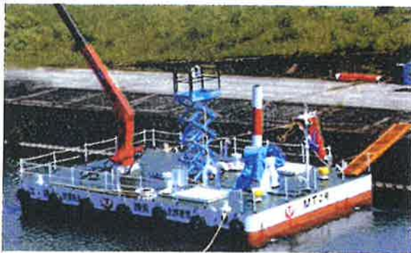
橋梁点検補修艇災害時物資輸送艇
